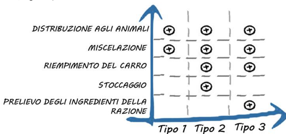
Figura 1: Le possibili tipologie di AFS e gli ambiti di automazione raggiungibili [Fonte: Rossi et al., 2021]
