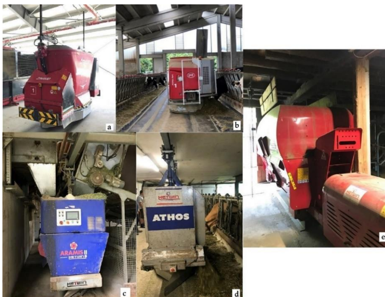
Figura 2: Tipologie costruttive di AFS. a) Miscelatore/distributore guidato; b) Miscelatore/distributore semovente; c) Miscelatore/distributore sospeso; d) Distributore sospeso; e) Miscelatore stazionario.
