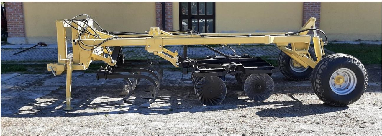
*Figura 1 – Il prototipo nella configurazione coltivatore ad ancore + erpice a dischi.*
