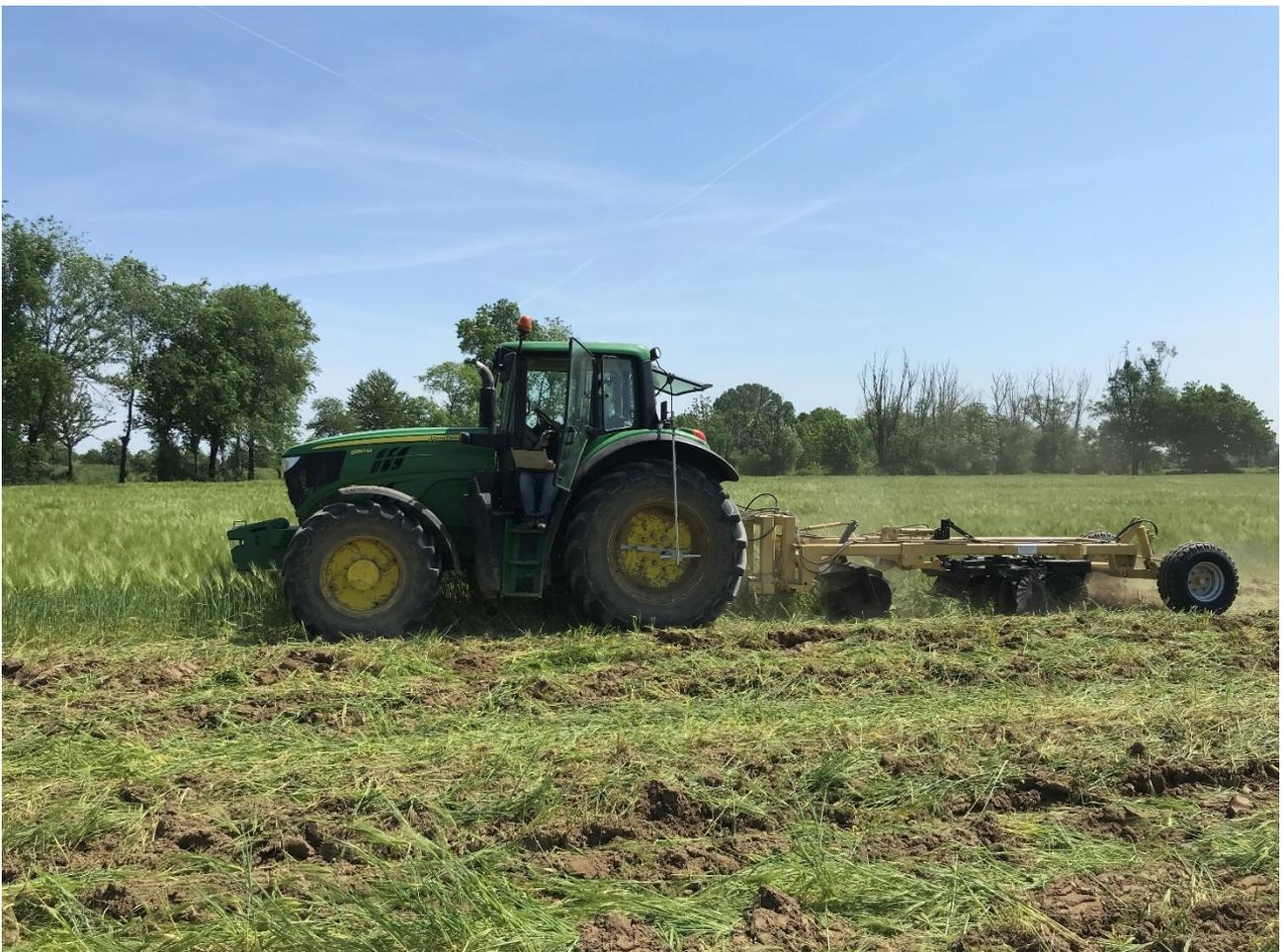
*Figura 2 – Il prototipo al lavoro nella configurazione rullo crimper+erpice a dischi.*
