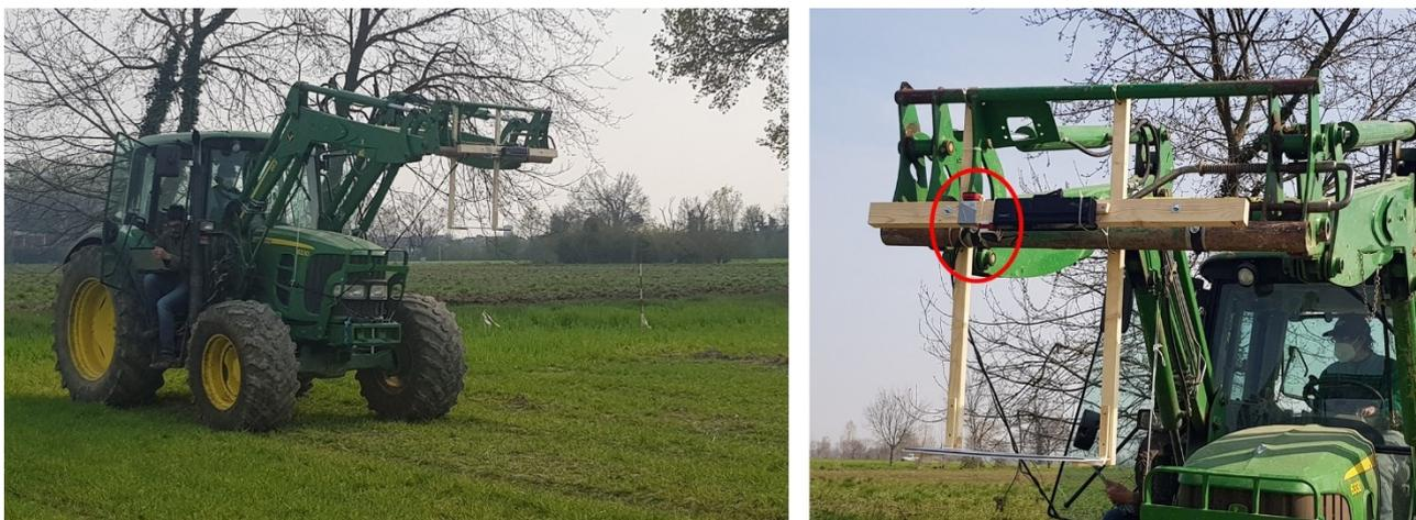
Figura 3 – Il monitoraggio della terminazione delle cover crop. A destra, in evidenza, la telecamera multispettrale impiegata.
