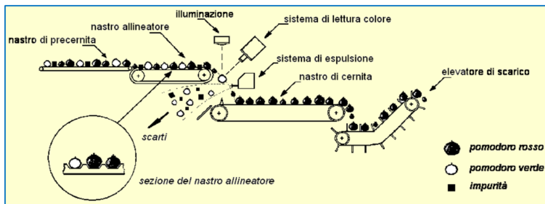
Figura 11. Schema di cernitrice elettronica per la raccolta del pomodoro (Monarca, 2020)
