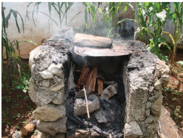
Fig. 3. La Sra. Macedonia dice que el fuego debe ser lento, lo mismo en un horno que si cubre las piezas con leña para “quemarlas”. El sol fuerte o el precocimiento excesivo pueden fracturar las vasijas.
