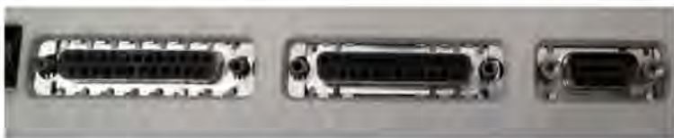
Figura 4.1: Connettori DB9 e DB25 sul retro di un terminale “vintage”
