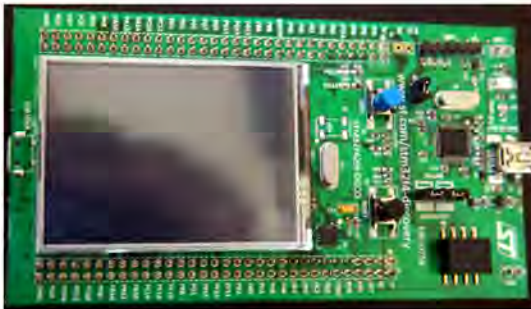
Figura 3.1: Una discovery board STM32 F429 dotata di LCD
