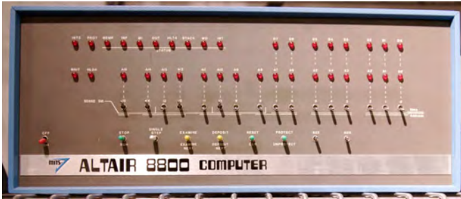
Figura 2.20: Pannello frontale di uno dei primi home computer, l'Altair 8800, pieno di LED (fonte: Todd Dailey)
