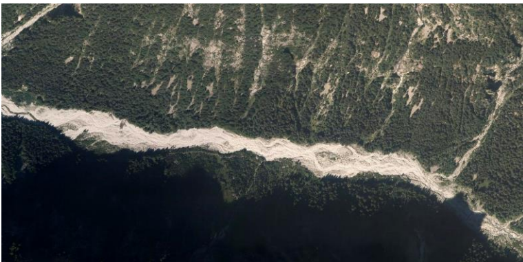
Fig. 7.19 – A sinistra: alveo braided del T. Codera in alta valle. Da Ortofoto AGEA 2012 (N verso destra). Sono visibili i canali e le barre fluviali.
