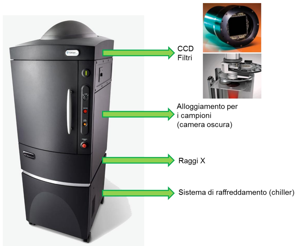
Fig. 14 – Sistema di imaging IVIS Spectrum CT (Perkin Elmer). Lo strumento è costituito da una camera oscura al cui interno è posto il sensore CCD e il sistema dei filtri in grado di rilevare l'emissione di fotoni dall'oggetto in esame.
