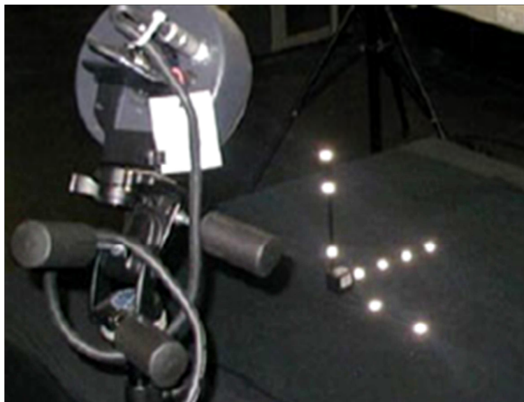
FIG. 4.12 - CALIBRAZIONE DEL SISTEMA SMART. Sono visibili una telecamera e la terna di riferimento.
