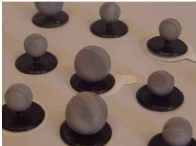
FIG. 4.11 Marker passivi riflettenti. Quelli utilizzati per il nostro protocollo hanno diametro di 1 cm e 0,5 cm.
