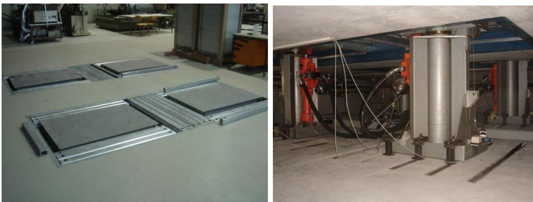
**Figura 2.15. Banco prova della Technische Universität di Berlino: a sinistra le piastre su cui vengono posizionate le ruote del trattore; a destra i cilindri idraulici alla base del funzionamento del banco.**
