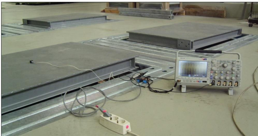
**Figura 4.38. Setup sperimentale impiegato per verificare il funzionamento del cilindro anteriore destro**
