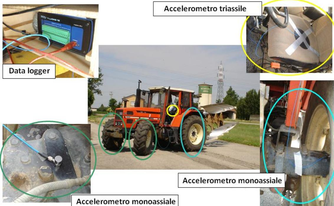
**Figura 3.8. Strumentazione montata sul trattore oggetto delle prove vibrazionali.**
