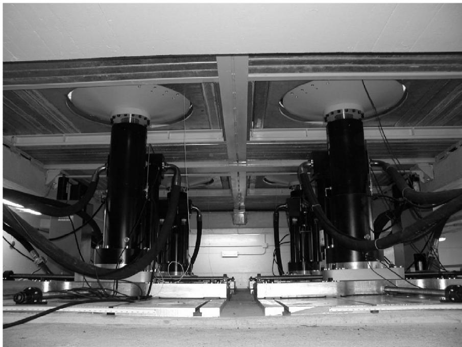
**Figura 3.3.** I 4 attuatori e il dispositivo di regolazione del passo del banco prova vibrazioni del CRA-Ing di Treviso. Al di sopra è visibile il pavimento in acciaio.
