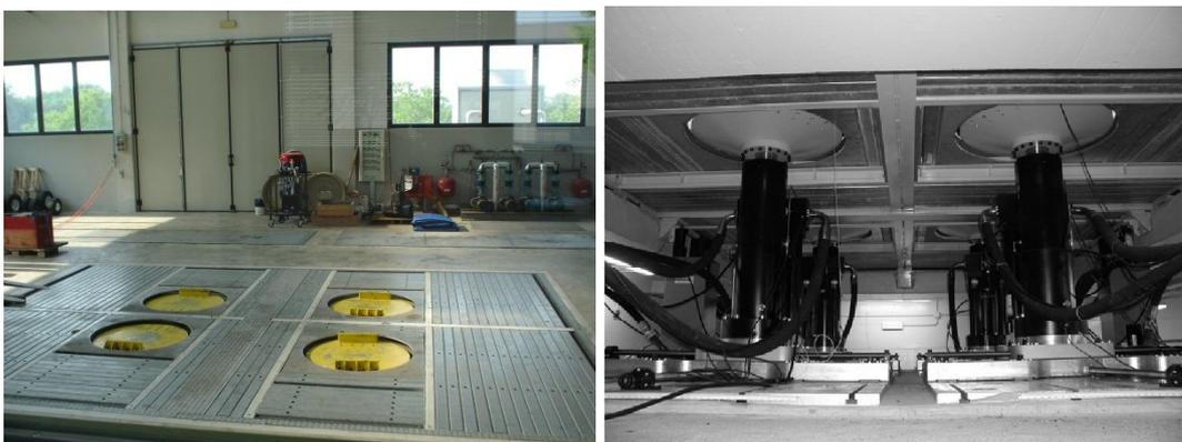
**Figura 2.14. Banco prova presso il CRA-Ing – Laboratorio di Treviglio: a sinistra le piastre su cui vengono posizionate le ruote del trattore; a destra i cilindri idraulici alla base del funzionamento del banco.**
