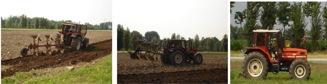
**Figura 18.7.** Il trattore analizzato in aratura: su terreno poco accidentato (TS, a sx); su terreno molto accidentato (TR, al centro); in trasferimento senza aratro né zavorra (a dx).
