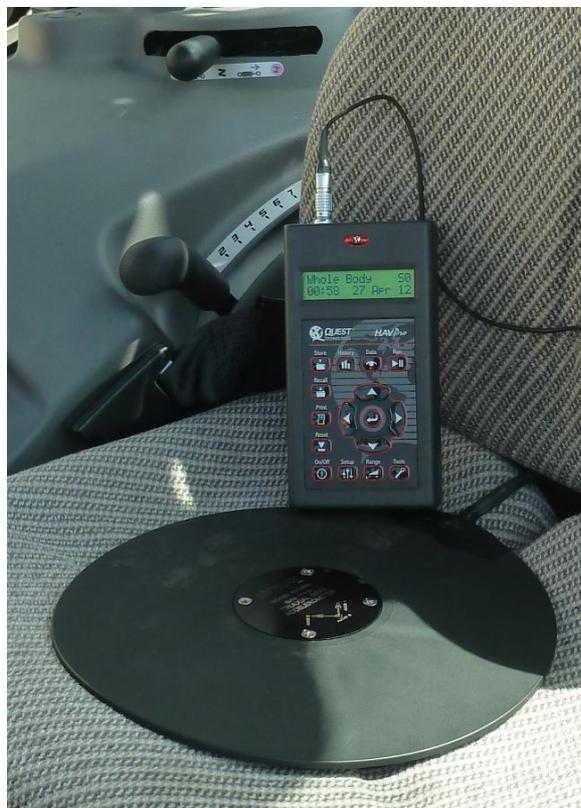
**Figura 3.16.** Per misurare i livelli vibrazionali relativi al corpo intero, sul sedile di guida è stato collocato un accelerometro triassiale con supporto a cuscino, collegato ad un analizzatore in tempo reale a 4 canali.
