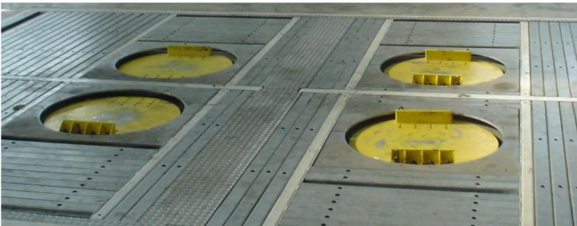
**Figura 3.5.** Particolare delle piastre su cui poggiano gli pneumatici del trattore di prova.
