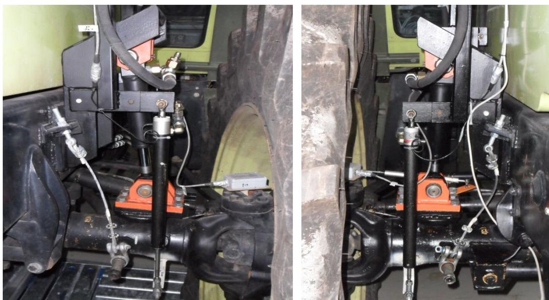
Figura 3.15. Dettaglio delle sospensioni anteriori, destra (a dx) e sinistra (a sx).
