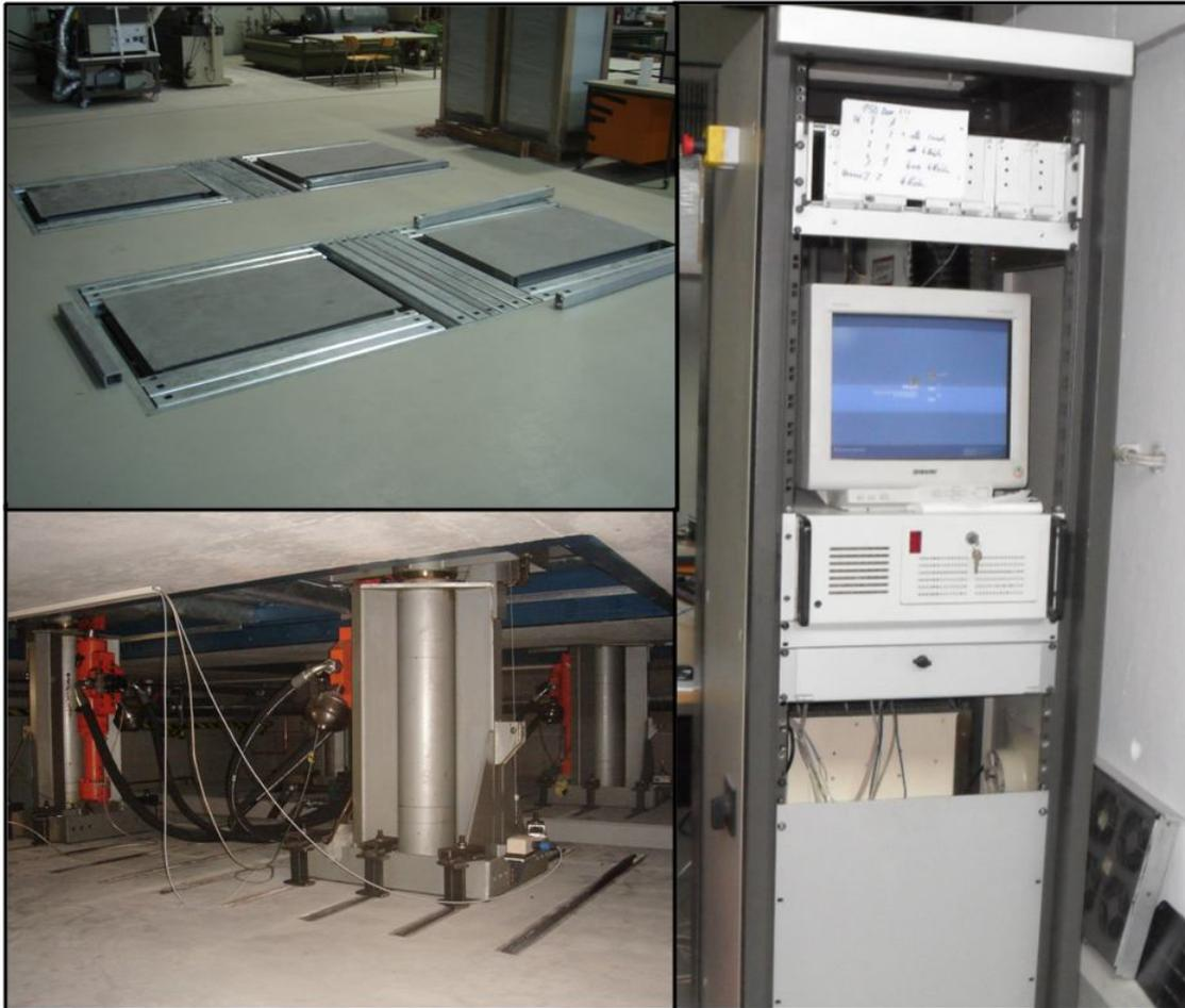
**Figura 3.10. Dettagli del banco prova vibrazioni installato presso il Dipartimento Konstruktion von Maschinensystem della Technische Universität di Berlino. In alto a sinistra: le piastre dove vengono posizionate le ruote del trattore; in basso a sinistra: i cilindri idraulici eccitatori; a destra: la strumentazione di controllo.**
