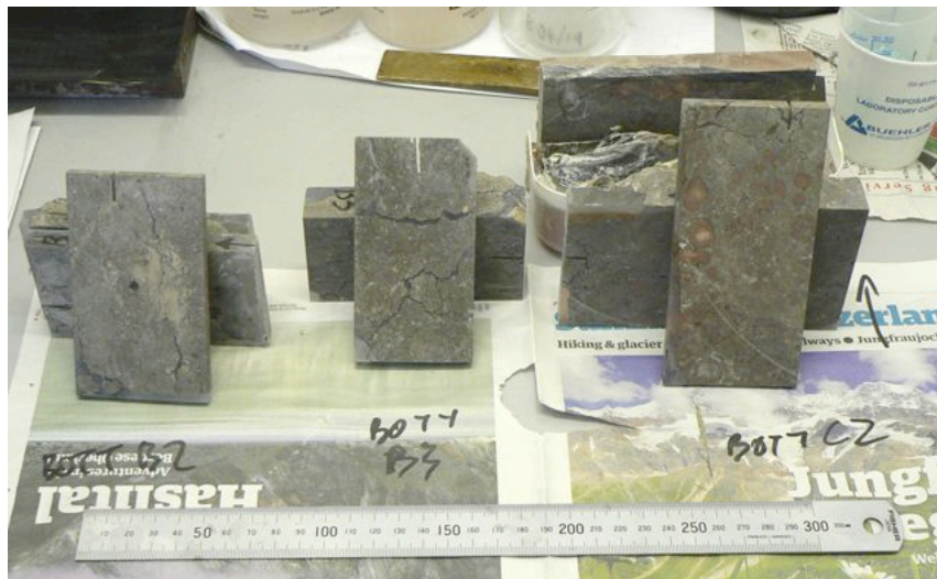
Fig. 2.3 Blocchi impregnati tagliati in fette di ca. 1 cm di spessore. La tacca nella parte superiore di ciascuna fetta viene incisa al momento del taglio ed indica l'alto del campione.
