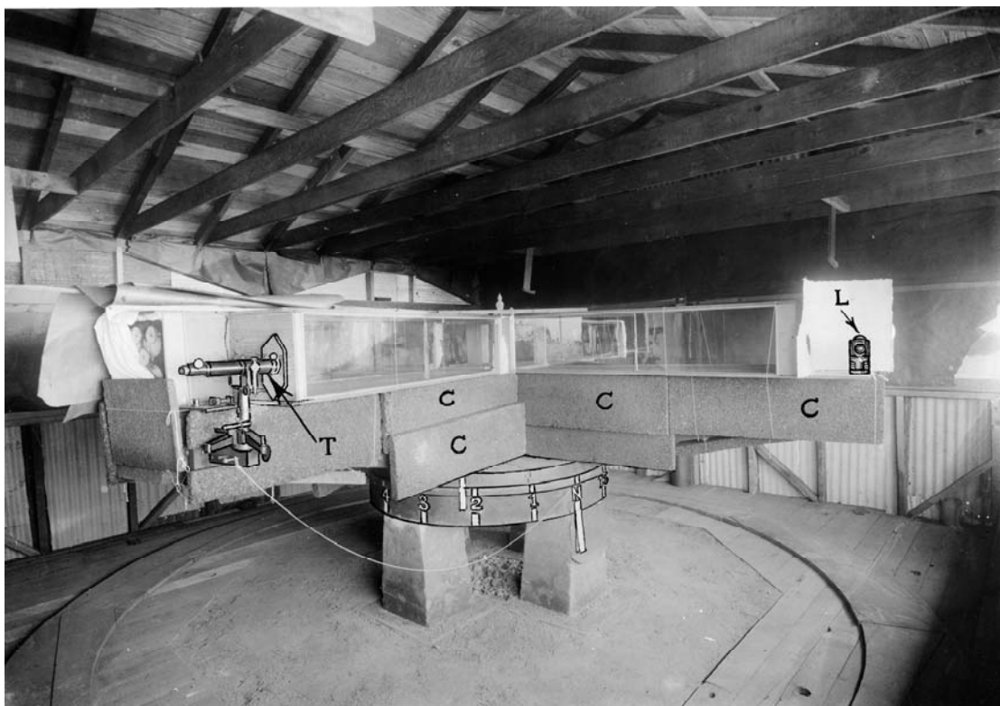
Figura 5.3. Interferometro usato da Miller a Mount Wilson nell'aprile del 1921. Foto mandata ad Arvid Reuterdaahl, Arvid Reuterdaahl Papers, per concessione della University of St. Thomas , Special Collections.
