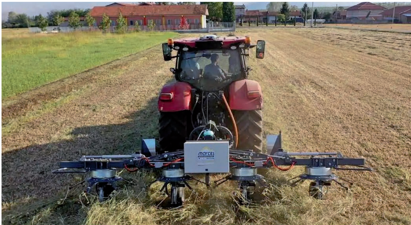
Spandivoltafieno azionato da un motore elettrico della Frandent Srl di Osasco (TO) Tedder powered by an electric motor from Frandent Srl of Osasco (TO)
