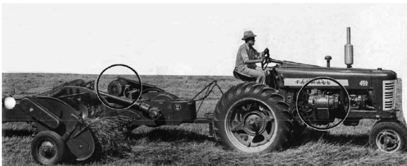
Il trattore Farmall 450 IH Electrall del 1954 accoppiato ad un'imballatrice per balle prismatiche McCormick 55, azionata elettricamente. In evidenza, l'alternatore montato sul trattore e il motore elettrico collocato sull'attrezzatura
