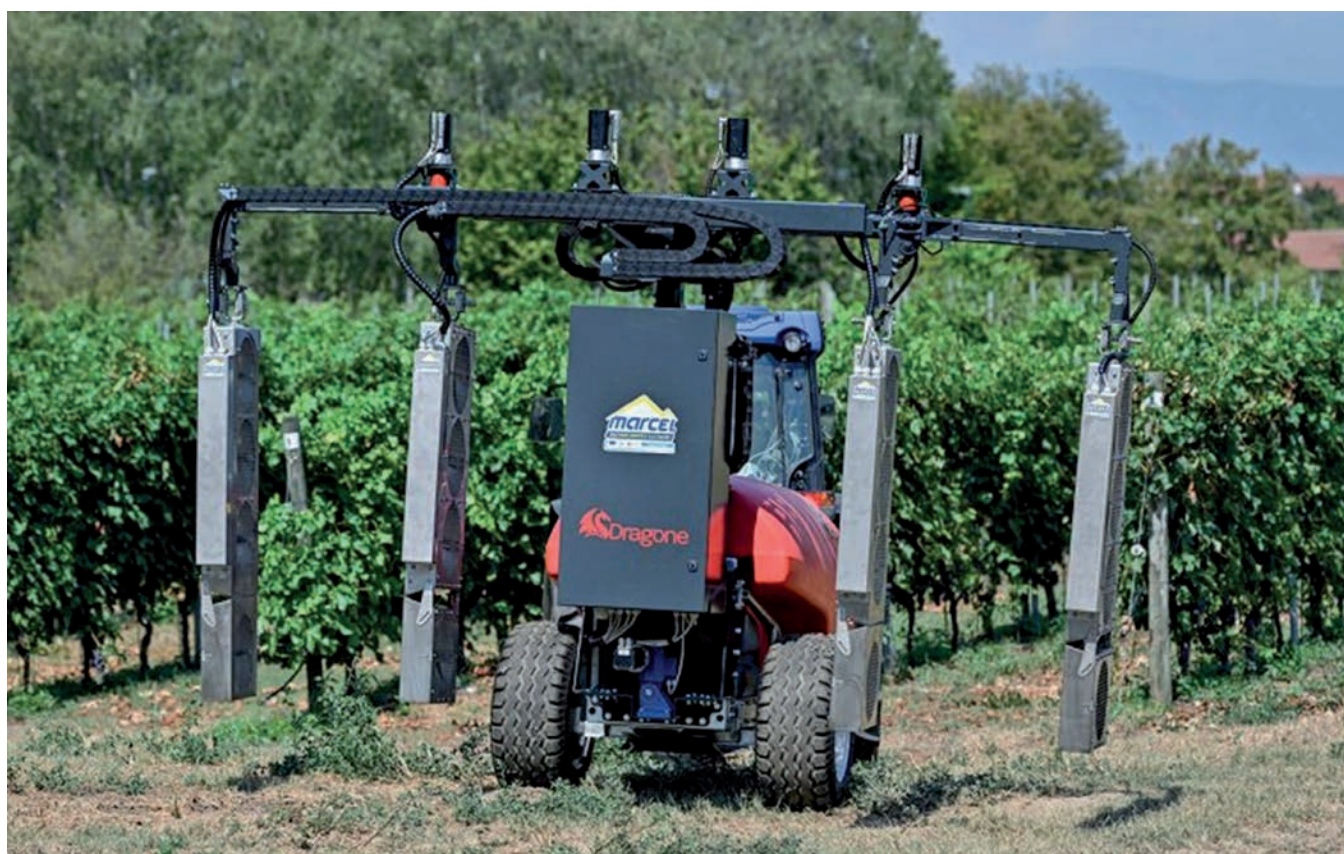
Irroratrice scavallante della Dragone Srl di Castagnole Lanze (AT), a gestione elettrica della portata dell'aria e del flusso della miscela Overhead sprayer from Dragone Srl of Castagnole Lanze (AT), with electrical air flow and the mixture flow control
