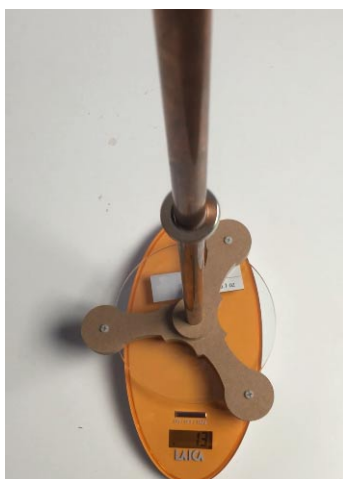
Fig. 9. – Tubo di rame con anello magnetica che sta cadendo, pesati da una bilancia.
