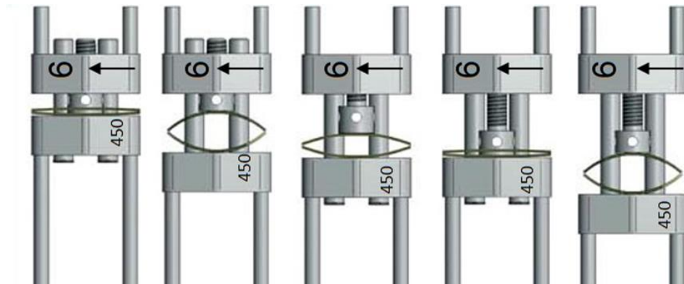
Fig. 7. - Esempio di riattivazione della doppia molla a balestra
