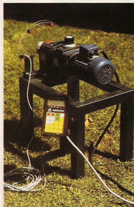
Foto 3 - Il gruppo motore elettrico-motoriduttore mediante il quale è stata simulata la velocità di avanzamento dello spandiconcime
