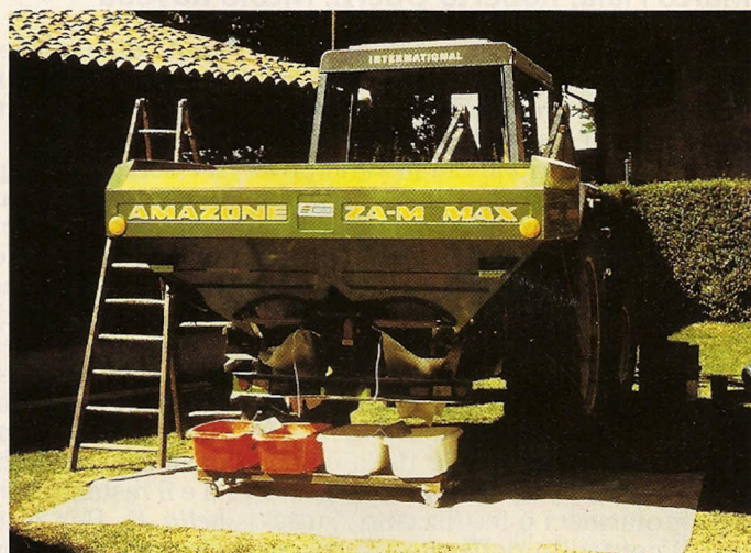
Foto 1 - Lo spandiconcime portato Z-AM Max 1500 della ditta Amazone equipaggiato con il sistema DPAE
