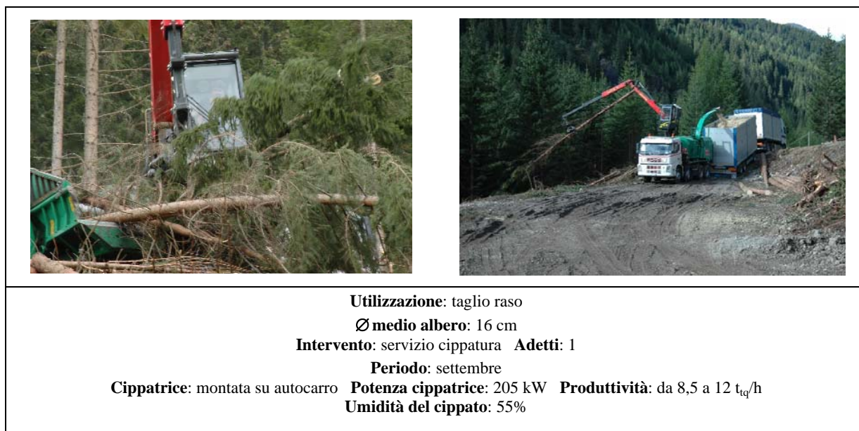
Figura 8 – Esempio di cantiere in contesto alpino che prevede la cippatura di alberi interi abbattuti da non più di una settimana. Il cippato viene successivamente trasportato con autotreno a un impianto di teleriscaldamento localizzato a 65 km di distanza.
