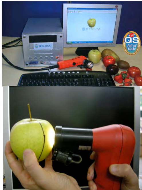
Figura 1. Sistema QS_200 di UNITEC SpA e particolare di acquisizione degli spettri Vis/NIR
