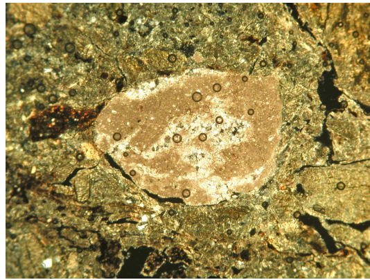
Fig. 27b VERSA ES SA - Calcite 40x xpl
