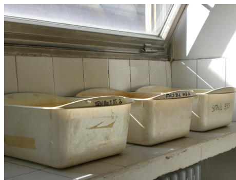
Fig. 11-12 A sinistra l'agitatore meccanico per setacci, sopra vasche di risulta della vagliatura ad umido piene d'acqua lasciate ferme a decantare.
