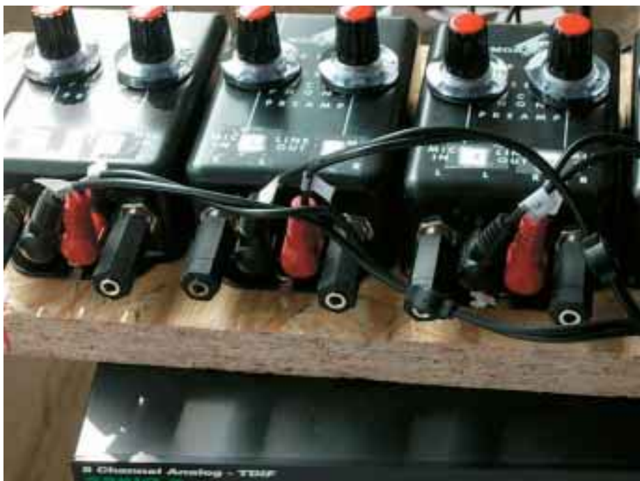
▲ Foto 3: preamplificatore e strumentazione per la registrazione del suono
